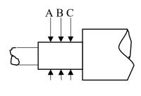
A. SHAFT RADIAL RUNOUT
